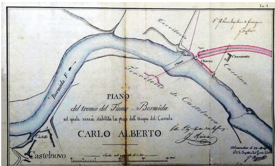
Fig. 3 – Progetto di Giovanni Negretti del 29 marzo 1833. Planimetria della presa del canale di Cassine presso la Bormida. Si notano i mulini natanti e la diga in legname.
